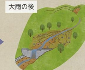
土砂がたまって川の勾配がゆるくなり、水の流れが遅くなる。
